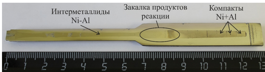
Рисунок 1. Шлиф образца с экструзией на 60 мм
