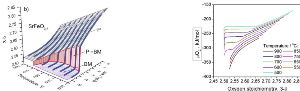
Рисунок 1. Равновесные изотермы 3-\delta - \lg pO_2 и рассчитанные из них зависимости химического потенциала SrFeO_{3-\delta} от кислородной стехиометрии
