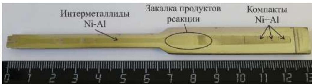
Рисунок 1. Шлиф образца с экструзией на 60 мм
