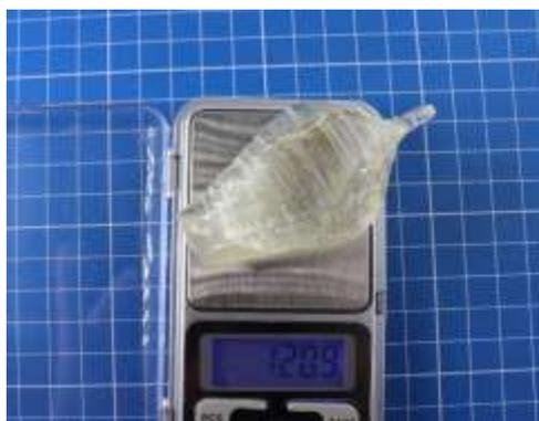
Рисунок. Монокристалл  $\text{LiNa}_5\text{Mo}_9\text{O}_{30}$
